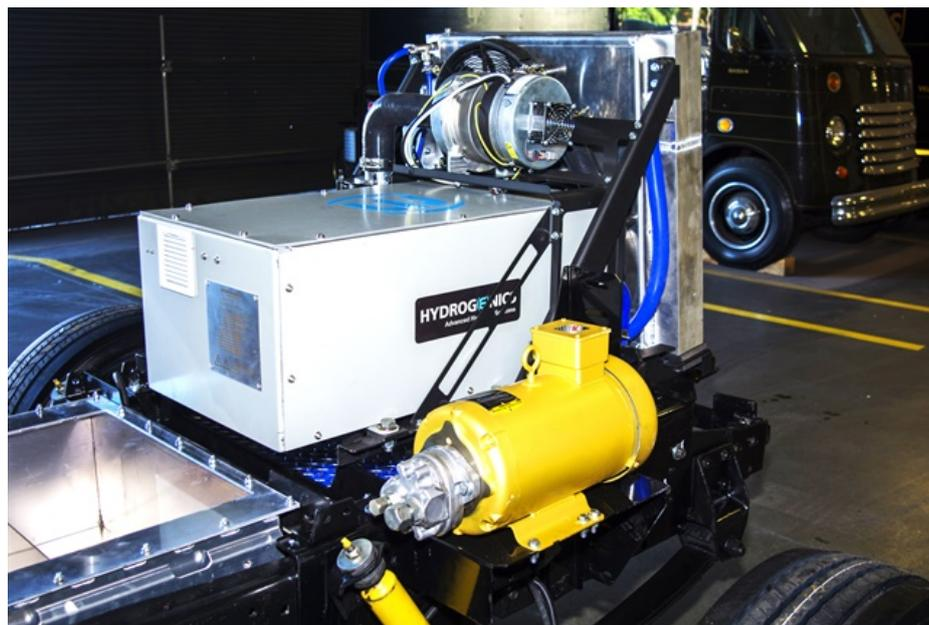
図. 搭載する Unique Electric Systems 社の FC システム
