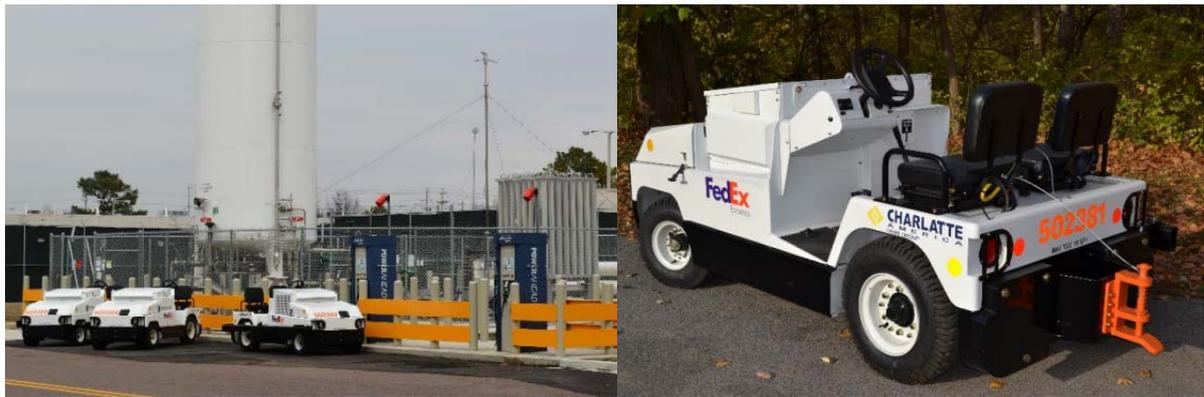
図. メンフィス空港に導入された水素ステーションとFCカーゴトラクター
