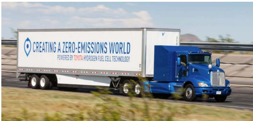
図. トヨタが開発した FC セミトレーラーの試験走行機
