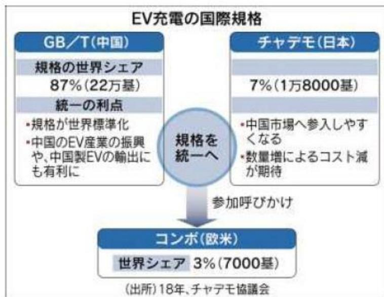
2. これら3規格の充電ステーションは現在 50kW 程度（一つのコネクター当たり。3規格とは別に Tesla の独自規格は～120kW）で運用している。3規格では出力増強の新規格策定を進めており、当面は下表のように 240kW～400kW 程度を目指した規格作成・導入が進行中である（CHAdeMO 協議会は 2018 年 5 月に 400kW の Ver.2.0 の規格を発行）。中国はさらに将来計画として 900kW の規格策定を決定している。
