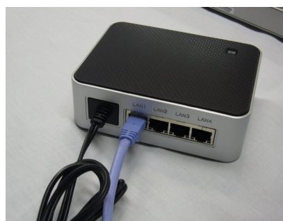
HN-VA40Sのうち、LAN端子が4つあるアダプター。背面にLAN端子があり、パソコンやプリンター、セッソップボックスなど複数の機器を接続できる
