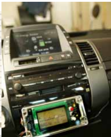
オリジナルのバッテリー制御システムに取って代わる EnergyCS社製のプロトタイプディスプレイユニット
